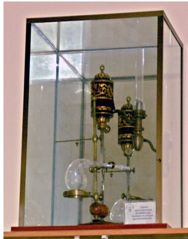
Soporte para experimento de químicas con quinqué.
